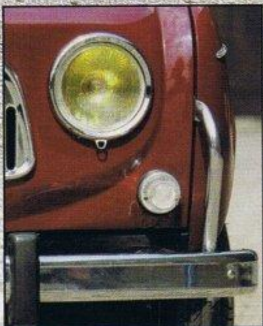
Bram a installé ces renforts de pare-chocs avant disponibles dans la catalogue de pièces détachées.
