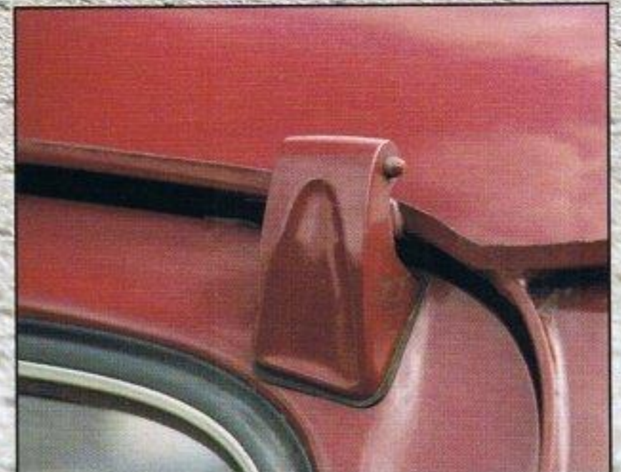
Terminées les fragiles charnières de hayon soudées, on trouve désormais ces nouvelles pièces boulonnées.
