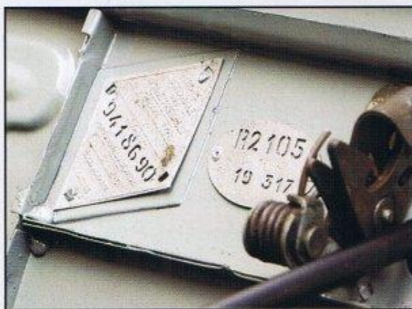
A partir de 1966, le type de la version 4 CV passe de R2102 à R2105... L'option 5 CV sera identifiée par le type R2106.
